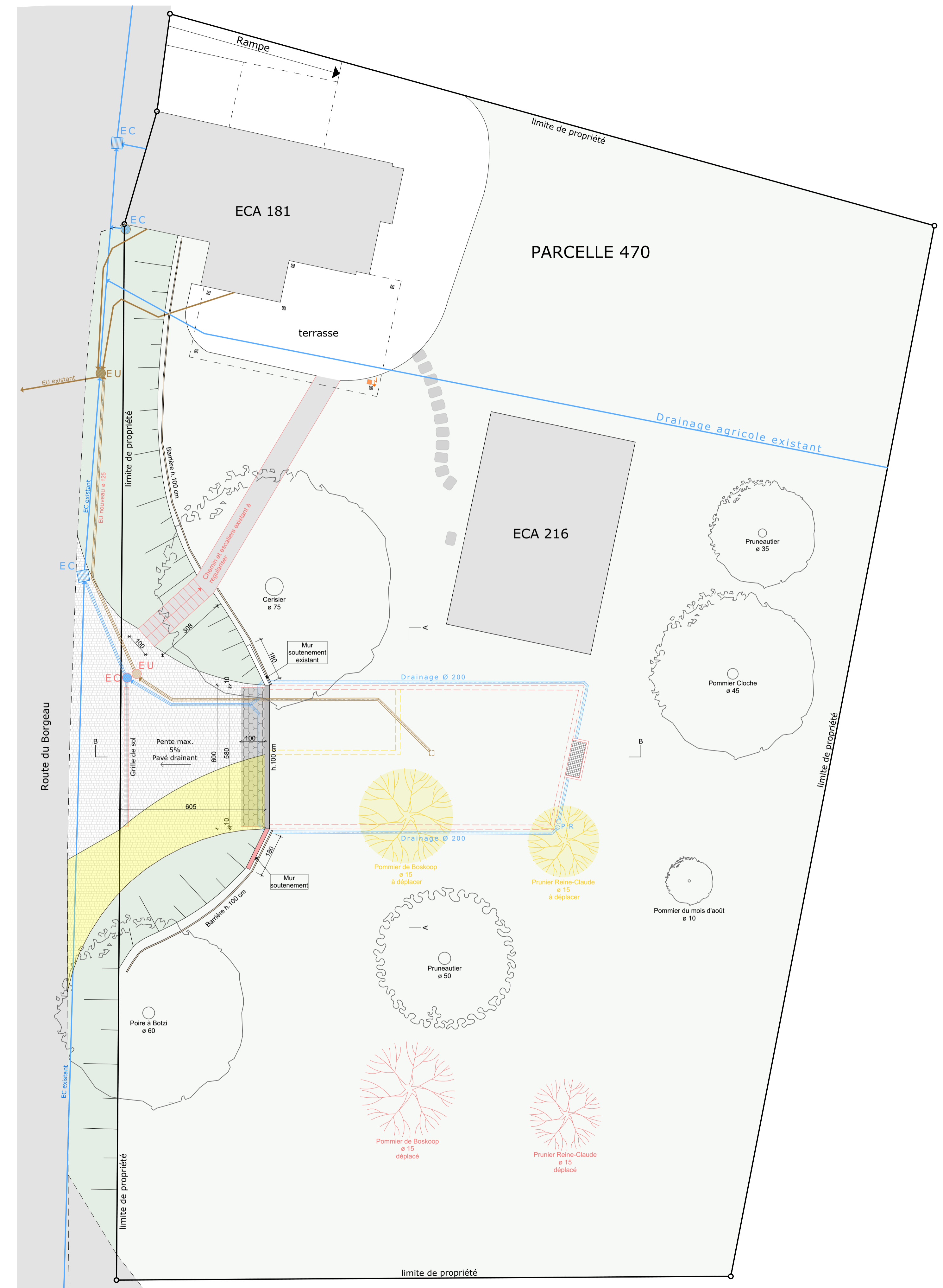
Rez-de-chaussée / Am. extérieur et canalisations
